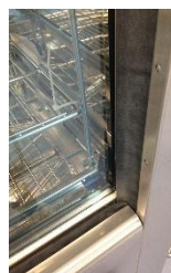
Système d'amélioration d'étanchéité interzone en place sur les LDI
