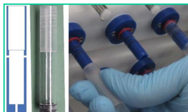
PIDTest ® et sa représentation schématique. Adaptation dans un automate
