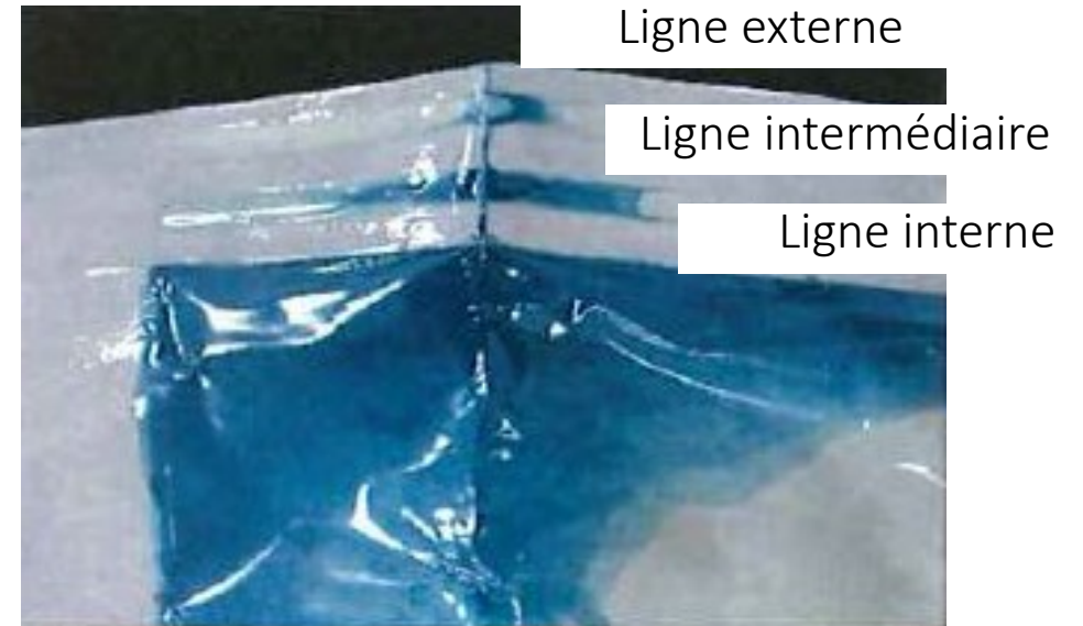
Cheminées sur la soudure industrielle après pliage du SBS
