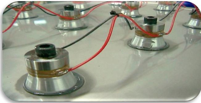
Figure 2 : transducteurs piézoélectriques
