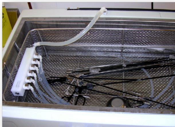
Figure 3 : bac ultrasons avec tubulures d'irrigation
